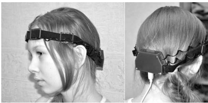
Рис. 1 Расположение прибора «Опторитмограф» на голове
